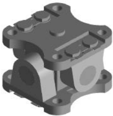
图 1 十字轴常平座结构示意图
