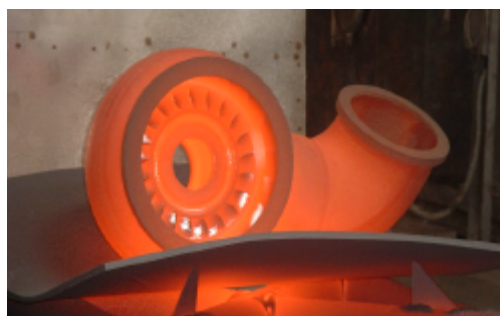
图 2 涡轮静子组件涂层出炉后的状态
