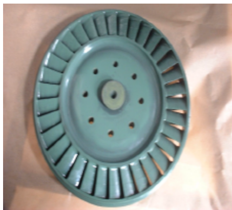
图 4 涡轮转子涂层外观
