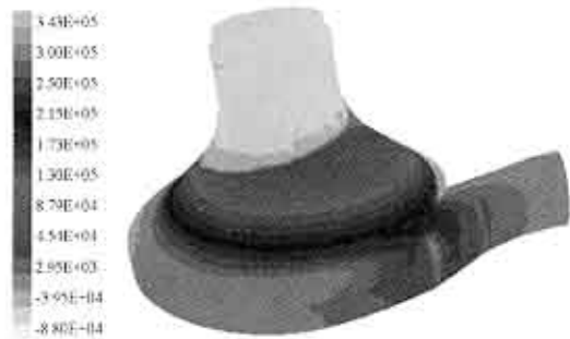
图 4 螺旋离心泵内压力分布
