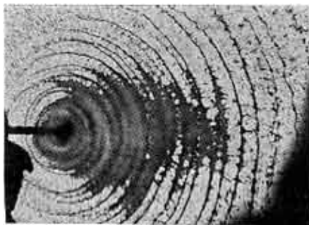
图2 d=0.7\text{mm} , u=35\text{m/s} , 2\theta=100^\circ 凝胶的雾化图像
