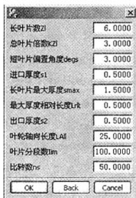
图6 叶片的设计参数(2)
