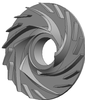
图7 叶轮(去掉前盖板)
