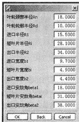
图5 叶轮的设计参数(1)
