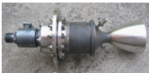
图 2 过氧化氢单组元催化分解发动机
