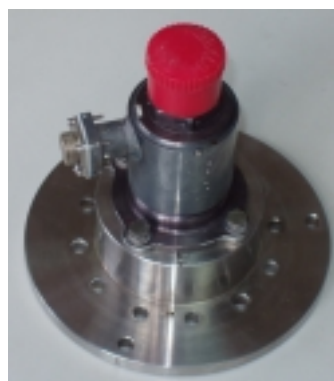
图 1 喷注器示意图
