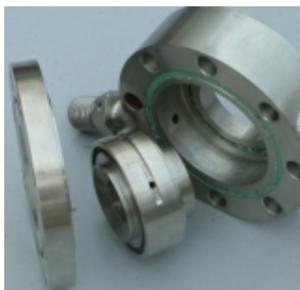
图2 横向喷注器组合件
