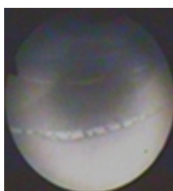
图 3 某导管内壁上的折迭检测照片 Fig.3 Fold photo checked on pipe inner wall
