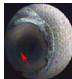
图 10 内咬边 Fig.10 Internal undercut
