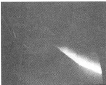
图 8 爆震波点火器高空条件下成功点燃塞式喷管发动机
