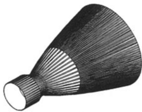
图 1 推力室铣槽内壁
