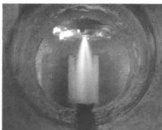
图 3 有气幕隔离装置的观察窗
