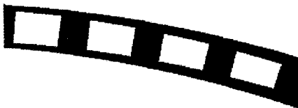
图4 夹层冷却通道几何模型
