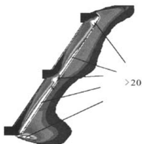
图 8 径向蒸发管内局部燃油分布
