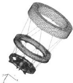
图 3 发动机试车台机架动力学模型 Fig.3 Dynamics model of the frame
