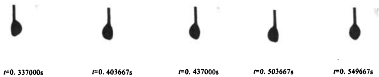
图 6 压力升高过程中液滴蒸发的系列阴影图像（试验 1）
