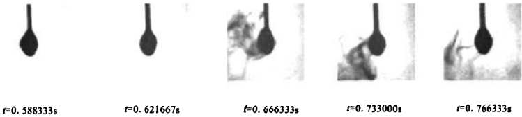
图 7 压力下降过程中液滴蒸发的系列阴影图像（试验 1）
