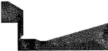
图 2 冷气推进器流场计算网格示意图 Fig.2 Grid for the nitrogen thruster
