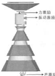
图 8 SEA 模型载荷示意图 Fig.8 Loads of SEA model
