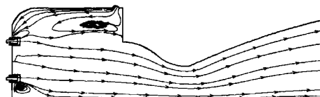
图10 推力室内流线分布图
