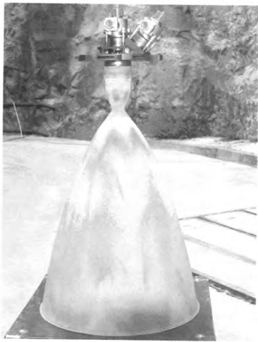
图 4 试车后的第 3 代 490 N 发动机 Fig. 4 The Third Generation 490 N engine after hot fire testing
