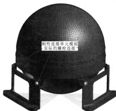
图 4 气瓶原结构动力学模型
