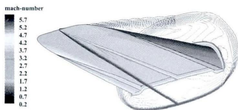
图 7 带抑流楔升力前体马赫数等值线图
