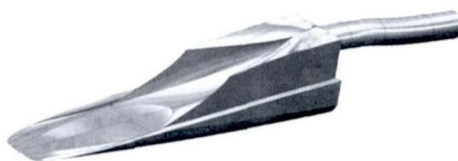
图 10 带抑流楔升力前体进气系统构型
