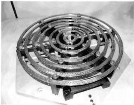
图 2 喷注器环偶数环状态夹具图
