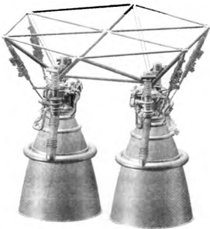
图 1 200 吨级氢氧发动机系统简图与模装图
