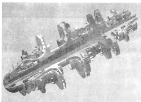
图 4 涡轮泵高速柔性转子
