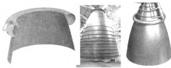
图 3 氢氧发动机推力室大喷管
