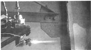
图 2 燃气发生器点火试验照片
