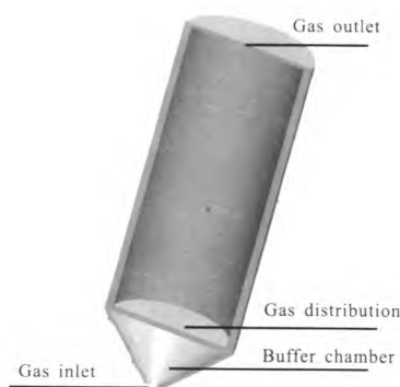
图1 沉积反应器立体模型
