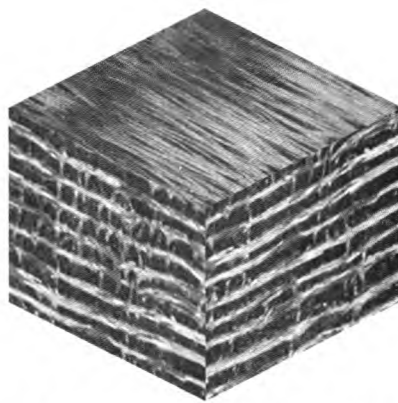
图 1 针刺碳纤维预制体三维立体图
