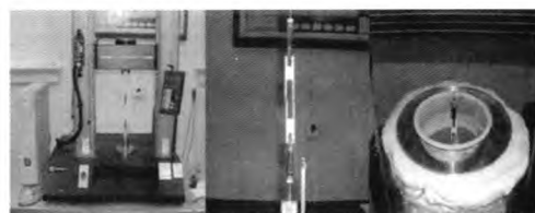
图 3 纤维拉伸试验装置
