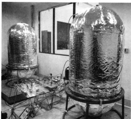
图 4 并联贮箱均衡排放试验系统
