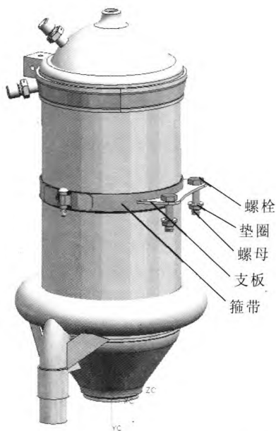
图1 燃气发生器固定连接三维模型结构
