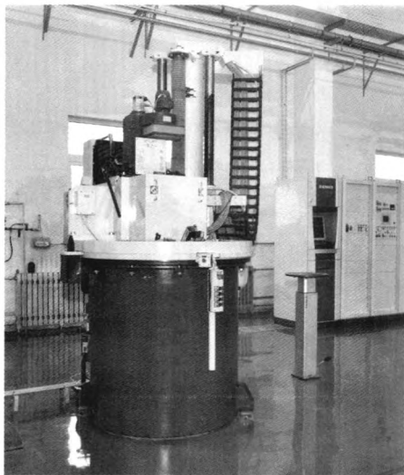
图 10 超速试验台 Fig. 10 High-speed tester
