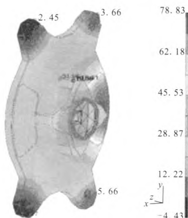
图 5 法兰温度云图(大法兰加热功率 5.0 W)
