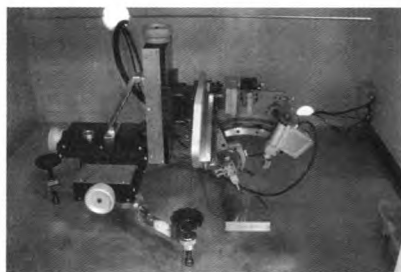
图 1 X-350A 型 X 射线衍射残余应力测试设备
