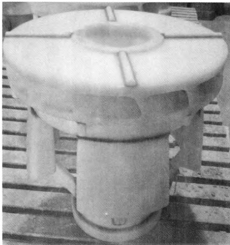
图 5 离心轮蜡模 Fig. 5 Wax pattern of centrifugal impeller
