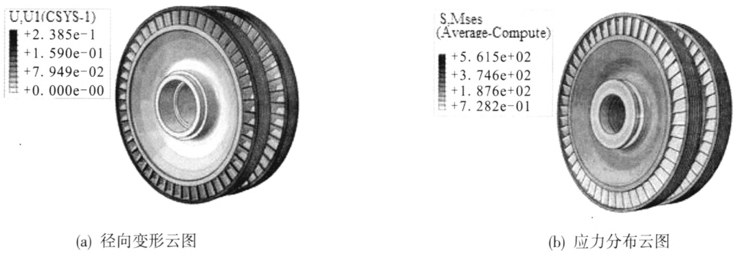
图 2 涡轮径向变形云图和应力分布云图
