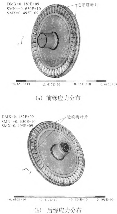
图 7 涡轮转子应力分布 Fig. 7 Stress distribution of turbine rotor
