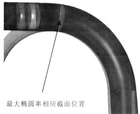
图 6 最大椭圆率截面 Fig. 6 Largest ellipticity section
