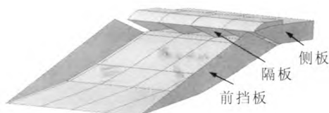
图 3 四模块进气道的三维气动构型(带挡板)
