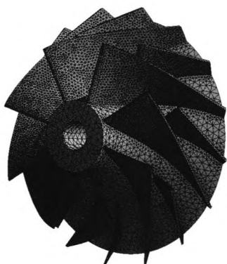
图4 有限元分析模型及网格 Fig. 4 FEA model and grids
