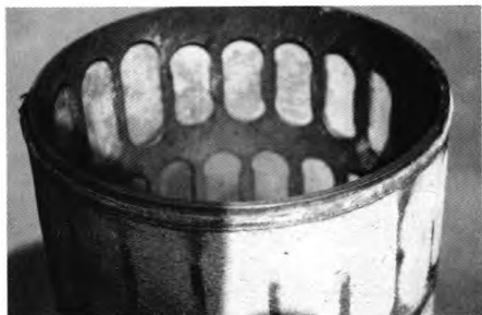
图2 过滤器滤网上白色硝酸盐
