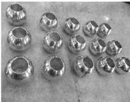
图 4 零件球加工成品图
