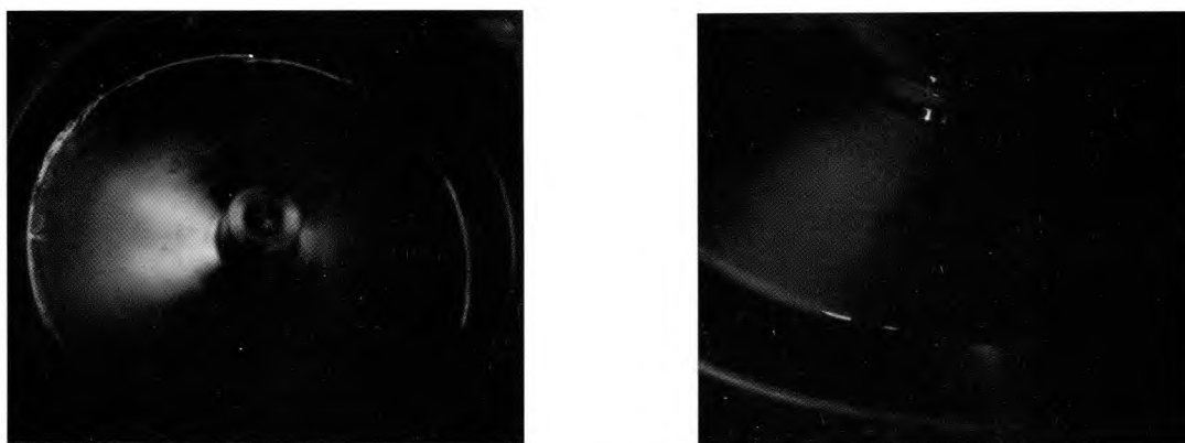
图 8 某型发动机涡轮泵涡轮盘裂纹形貌(荧光检查状态下)
