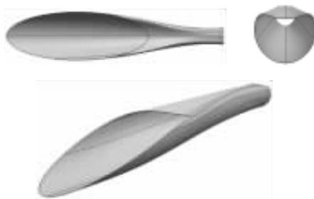
图 3 进口水平投影为椭圆的进气道构型
