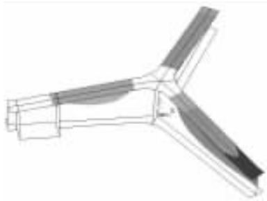
图 6 复合材料机架的一阶失稳模态 Fig. 6 The first-order buckling mode of composite thrust frame
