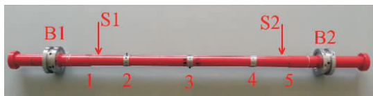
图 2 试验转子实物图(1~5 为平衡校正面; S1 和 S2 为振动位移测量面)
