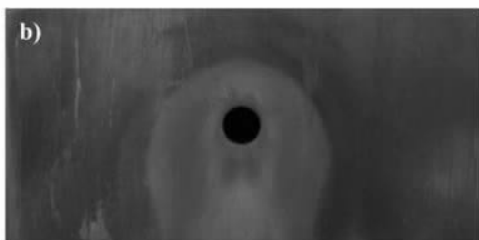
图 6 喷孔周边的热痕对比图
