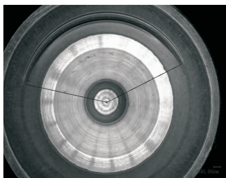
图 2 卸荷开关阀芯非金属压痕
