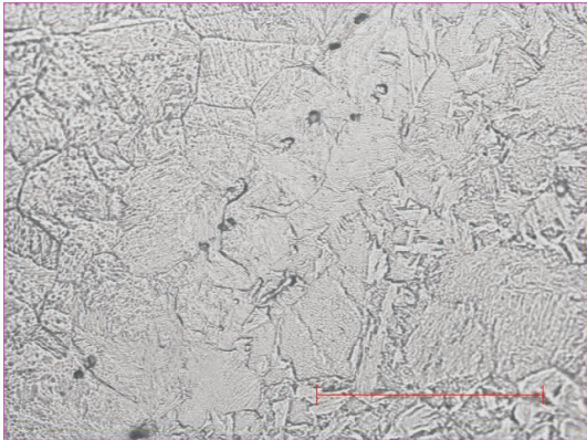
图 5 固溶后的金相组织 Fig. 5 Microstructure after solution treatment
