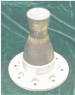
图 2 铱/铼 - 碳/碳燃烧室 (带铌连接环)
