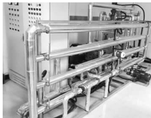
图 1 流阻测试试验系统
