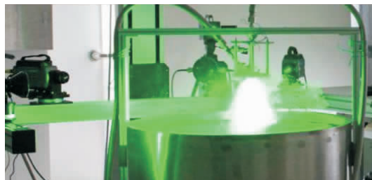
(b)头部冷流PIV测试
